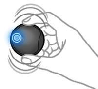
3. Agganciare il sensore Oxa nella parte anteriore dell'indumento. Individuare i contatti e assicurarsi di inserire il sensore con l'orientamento giusto, in modo che tutti i pin siano collegati correttamente.
