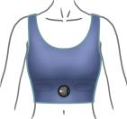
Fixez le capteur Oxa sur le devant du vêtement. Localisez les broches et insérez le capteur dans le bon sens afin que toutes les broches soient correctement connectées.
