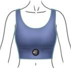
Der Oxa-Sensor wird an der Vorderseite des Kleidungsstücks befestigt. Finden Sie die Kontakte und stellen Sie sicher, dass Sie den Sensor richtig herum einsetzen, damit alle Stifte richtig angeschlossen sind.
