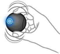
3. Engancha el sensor Oxa en la parte delantera de la prenda. Localiza los contactos y asegúrate de que introduces el sensor de forma correcta para que todos los pines estén bien conectados.
